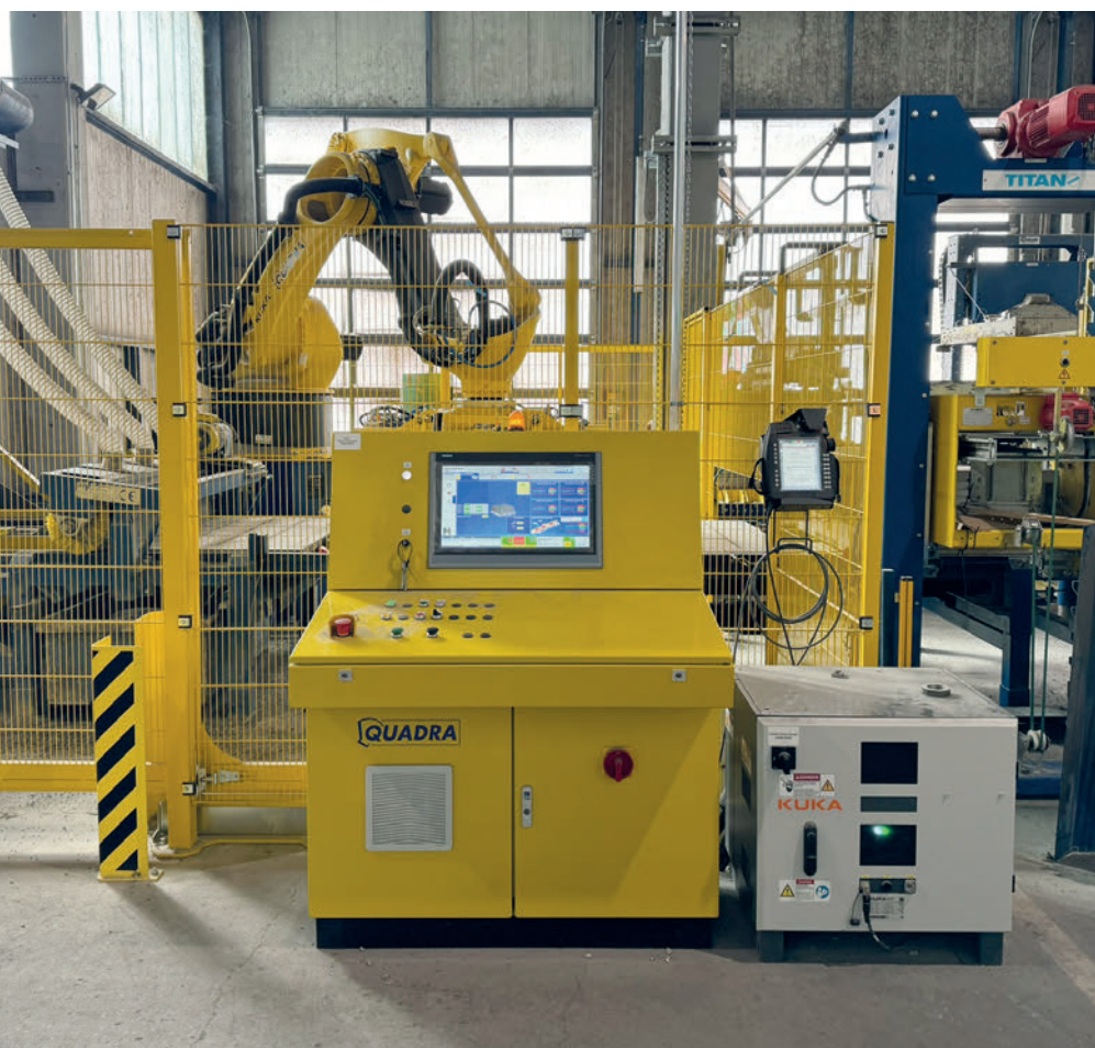
Fig. 1: Los parámetros de la fórmula pueden ajustarse desde el puesto de control.
